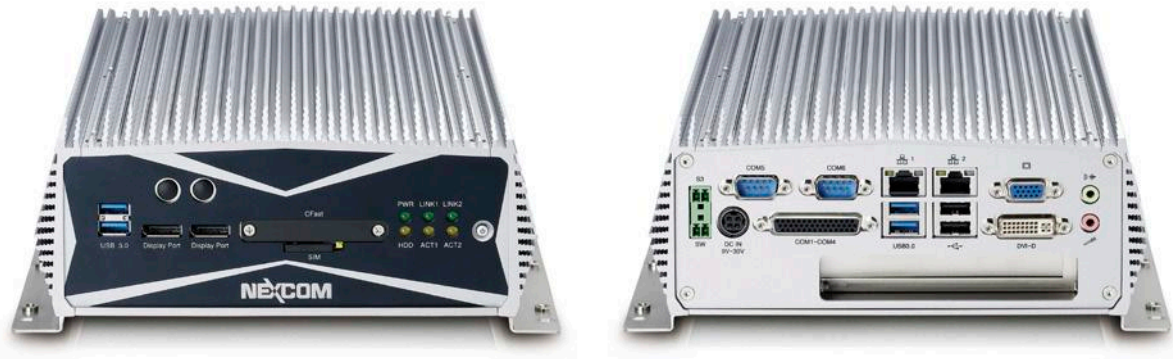
图 2 NEXCOM NISE 3600E 的前面板上设置有两个 DisplayPort 接口（如左图所示），后面板设置有 DVI-D 和 VGA 接口（如右图所示）。
