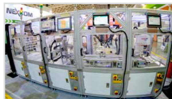
ノベルティ配布ボールペン刻印システムの概要 （右から SCALA、DELTA ロボットでピックアップ、レーザーで刻印し、6軸ロボットで倉庫に見立てた棚に一時保管）
