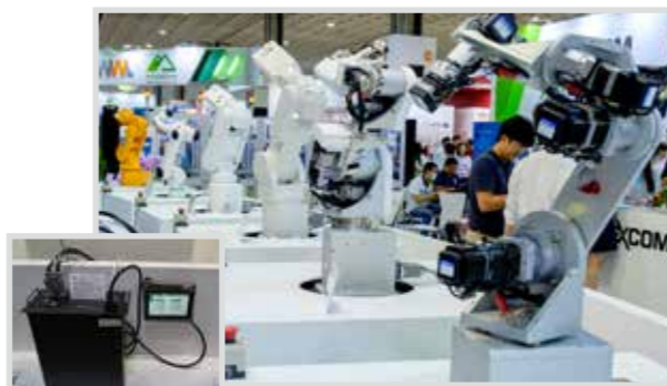
コントローラキャビネット メーカー各社のロボットを同期・制御
