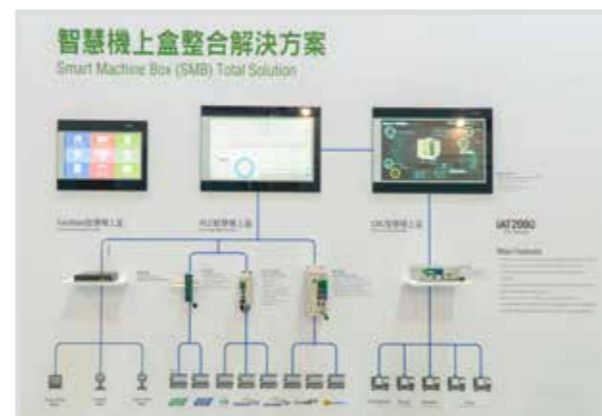
異なるフィールドバスをゲートウェイで接続し Cloud SCADA で管理
