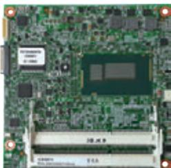
ICES 671 は 95x95mm のコンパクトサイズの COM Express Type 6 規格に準拠したモジュールで、第 4 世代 Intel® Core™ i7/i5/i3 プロセッサと最大 16GB の DDR3L 1600MHz SDRAM So-DIMM ソケット x2 本を搭載しています。内蔵の Intel® HD グラフィックスにより Microsoft DirectX® 11.1 をサポートし、PICMG が制定する COM.0 Rev. 2.0 規格をベースに PCI Express (x16) スロット x1 の他、DDI (Digital Display Interface) ポート x3 を備えています。
