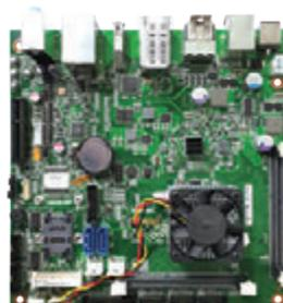
NEX 616 はクアッドコア Intel® Atom™ E3800 プロセッサー (最大 1.91GHz) と、So-DIMM ソケット x 2 最大 8GB DDR3L 1066/1333MHz SDRAM の搭載に対応したコンパクトサイズの産業用 mini-ITX マザーボードです。
