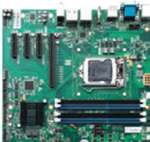
NEX 885 は LGA1150 ソケットタイプ第 4 世代 Intel® Core™ i7/i5/i3 プロセッサと Intel® Celeron® プロセッサ搭載対応の産業用 micro-ATX マザーボードです。4 本のメモリソケットを備え、最大 32GB の 1066/1333/1600MHz DDR3(デュアルチャンネル)をサポートしています。
