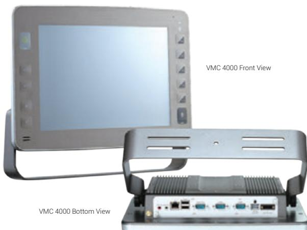
VMC 4000 シリーズは 12.1 インチサイズに必要な機能をまとめたオールインワンタイプの車載用パネルコンピューターです。ロジスティクスや資材運搬車両への搭載をターゲットとしています。Intel® Atom™ から Intel® Core™ i7 までのアプリケーションに合わせたパフォーマンスをお選びいただけます。その他、産業用グレードの LCD パネルや、最大 1000nit の高輝度、5 線式抵抗膜方式タッチセンサーなどを備えています。
