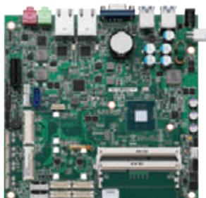
NEX 615 は高さ 25mm 以下の薄型産業用 mini-ITX マザーボードです。クアッドコア Intel® Atom™ E3800 プロセッサー (最大 1.91GHz) と、So-DIMM ソケット x 2 最大 8GB DDR3L 1066/1333MHz SDRAM の搭載に対応しています。
