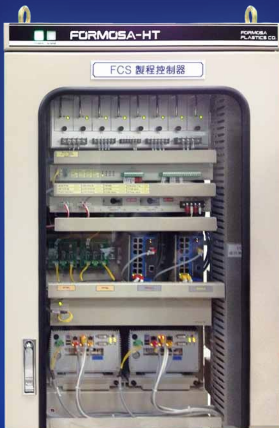
図 2. FORMOSA-FX* システムではネクスコム NISE* 3660 が DCS として活用されている。
