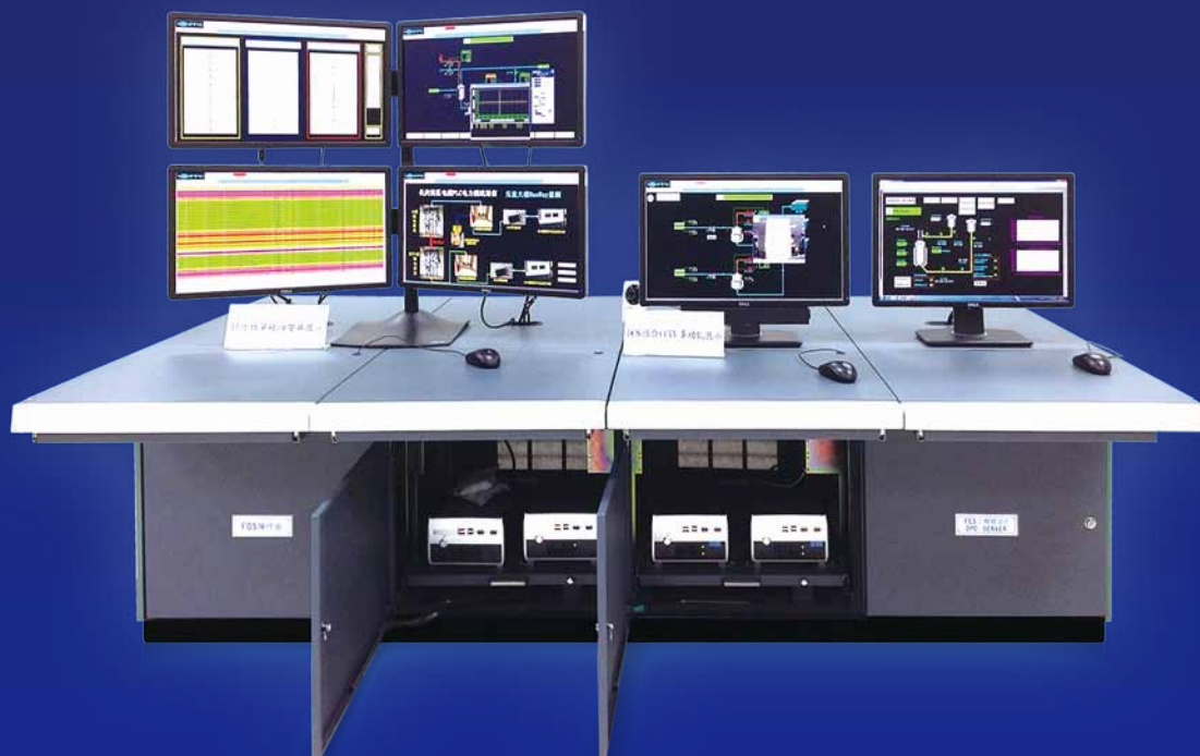
図 1. FORMOSA-FX* DCS ではネクスコム NISE* 3660 が MMI として活用されている。
