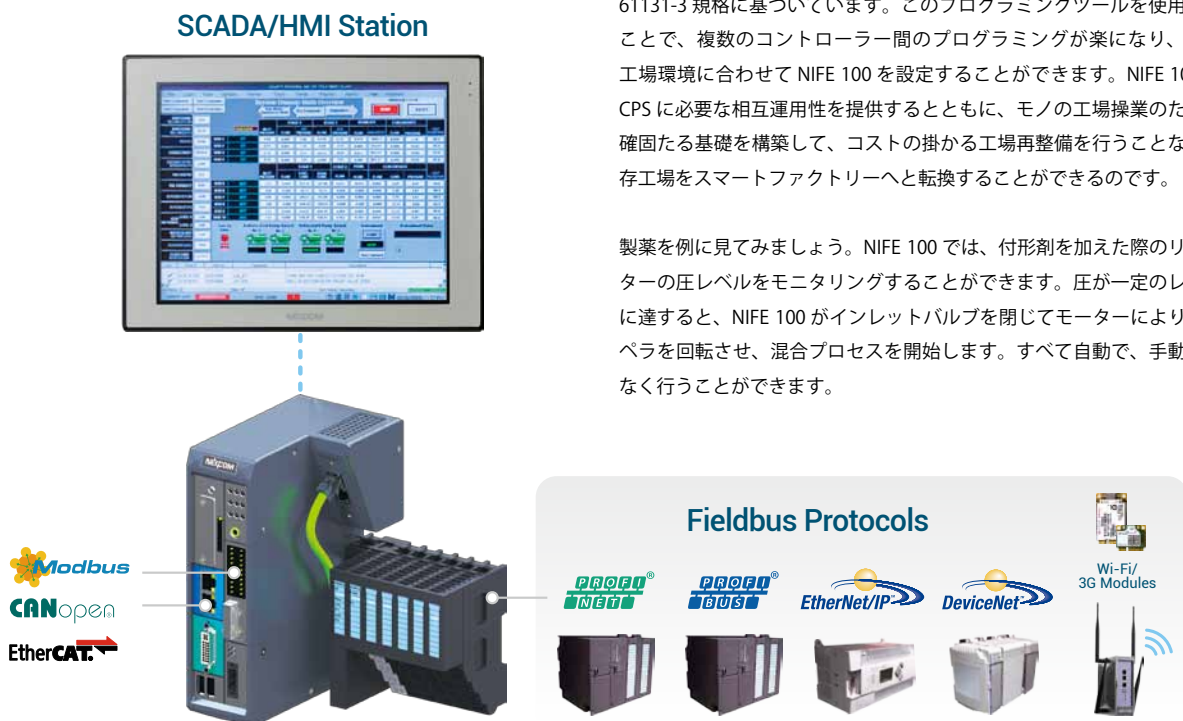
図 2. フィールドデータを集計するため、NIFE 100ではフィールドバス通信と3G/LTE/Wi-Fiネットワークの両方に対応。
