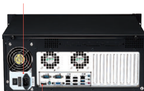
ATX, LGA1155, 最大拡張スロット x7 産業用マザーボード搭載
