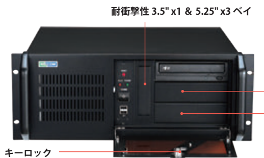
PBOX 520A フロント部
