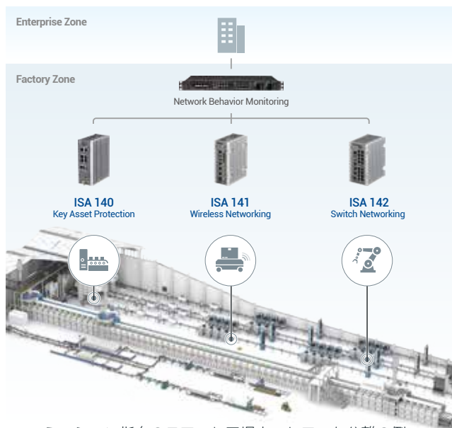
ミッション指向のスマート工場ネットワーク分離の例
