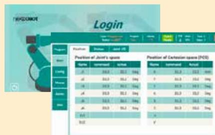
NexTPUI は産業用ロボットのアプリケーションと開発のためのヒューマンマシンインターフェース (HMI) ソフトウェアです。設定ファイルをインポートした後、ティーチペンダントでプログラムしながらロボットを操作することができます。
