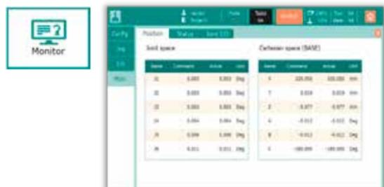
ロボットの位置、状態、I/O 信号を含むパラメータ監視により、現在のロボットすべての関連パラメータを知ることができます。
