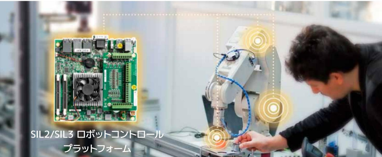
安全柵などで分断されることなく、作業員がロボットシステムの近くで作業をすることが出来る産業用ロボットの協働アプリケーションは、製造業にとって重要な資産となりつつあります。しかし、その実現のためには、ロボット本体が安全規格に適合することに加え、産業用協働ロボットシステムを含めた作業環境の安全要求事項に適合する必要があります。基本制御システム以外に付加される、人間の安全を確保するための安全関連制御システムで実現する機能を、機能安全と呼び、ロボットシステムのリスクを許容できる程度まで低減するための要求事項が定められています。
