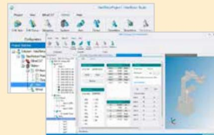
NexMotion Studio は、EtherCAT トポロジや、ロボットのコンフィグレーション、パラメータ設定などをするための、ソフトウェアコンフィグレーションツールです。
