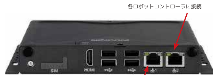
外部コンピュータから SRB100 に接続しコントローラの状態を監視するために使用
