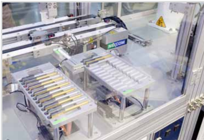
ロボットがボールペンをピックアップしレーザー刻印
