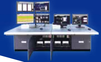
FORMOSA-FX DCS では NEXCOM の NISE 3660 が MMI として活用されている
