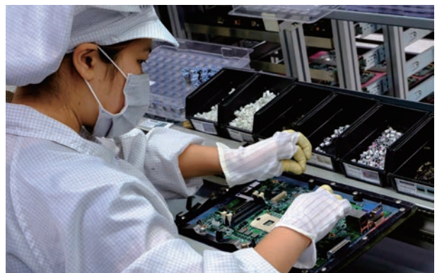
SOP に基づき DIP 作業を行うオペレータ
