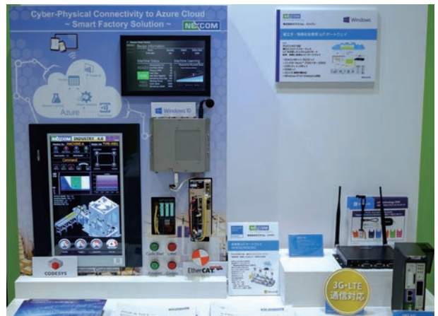
ソフトPLC「CODESYS」を搭載したパネルPC(左)とAzureと連携するNISE50
