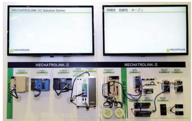
オープンフィールドバスMECHATROLINK-III通信を活用し機器の高速化を最大限にサポートする様々な対応機器を一覧できる展示コーナー
