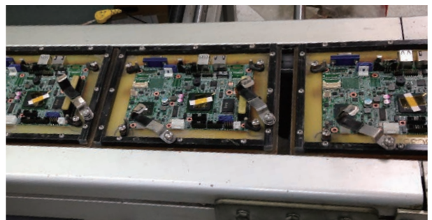
DIP ラインのキャリアと部品固定のための治具
