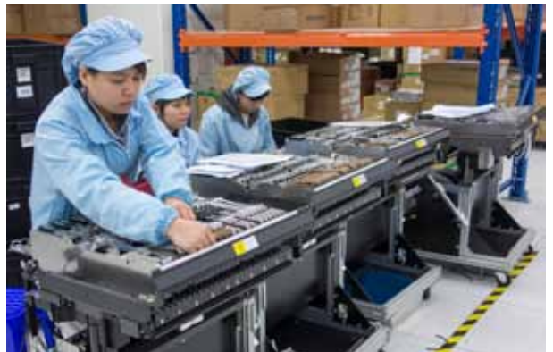
リールの交換作業
