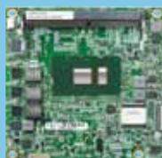
ICES 5100 シリーズは医学教育や訓練システムの教材として必要とされるバーチャルリアリティ (VR) シミュレーター向けに 3D や 4K グラフィックスの描画パフォーマンスを提供します。モジュールは次世代 HEVC/H.265 コーデックと DDR4 メモリソケットの他、フレキシブルな映像出力端子と共に、第3世代 PCIe や USB 3.0 の I/O を備えています。医療従事者の技能訓練環境の構築に適した動作性と処理パフォーマンスを提供します。
