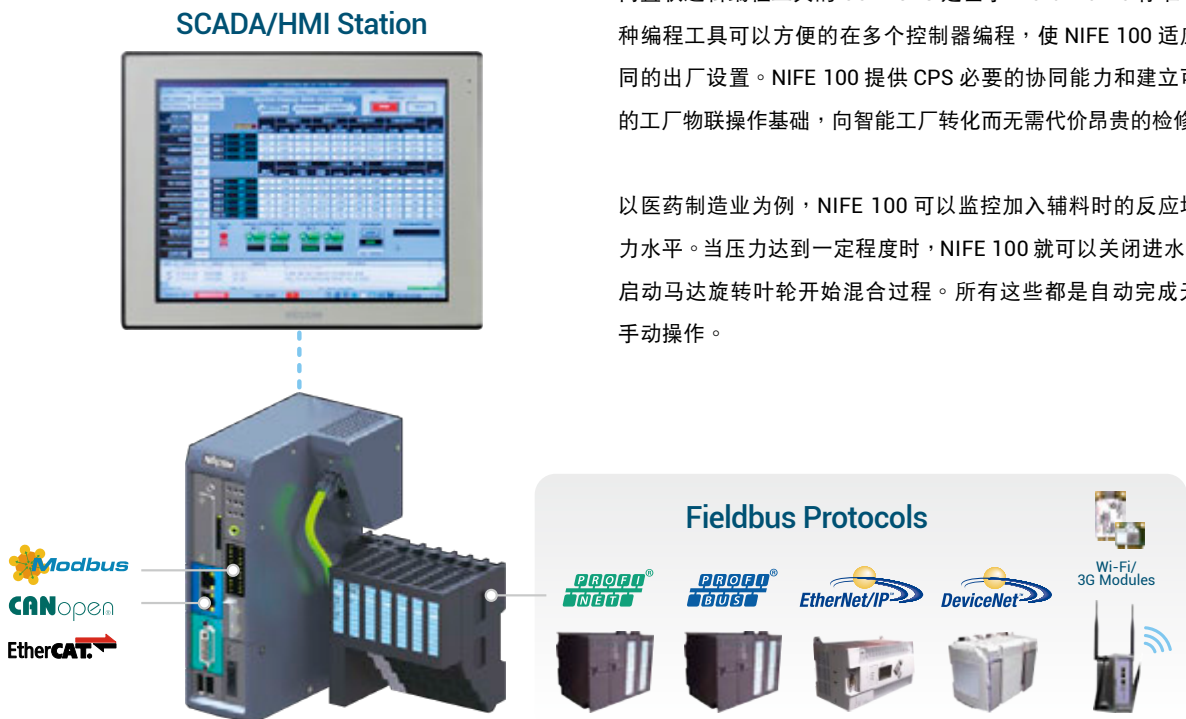
图 2. 聚集现场数据，NIFE 100 同时支持现场总线通讯和 3G/LTE / Wi-Fi 网络
