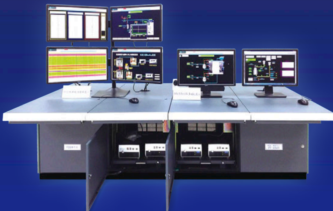
图 1. FORMOSA-FX DCS 使用新汉 NISE+ 3660 作为人机界面
