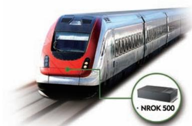
专为铁路行业应用而设计, NROK 500 无风扇工业计算机采用低功耗 Intel® Atom™ D525 1.8GHz CPU. 应对运输自动化应用, NROK 500 集成了M12 以太网接头, 专为工业应用中多种环境而设计, 高集成功能确保了特殊环境的稳定运行, 如高冲击和振动。此外, NROK 500 配置了 SIM卡安装孔, CF槽, 和 Mini-PCIe槽作为可选的3G无线连接, 并为用户提供完整和弹性的数据采集方式。NROK 500作为火车专用工业计算机, 同时符合 EN50155 规范。
