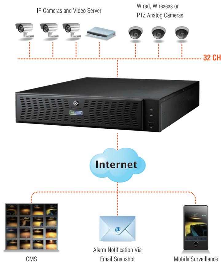
图1 混合NVR可以弹性管理，智能报警，远程查看，同时支持模拟和数字视频流
